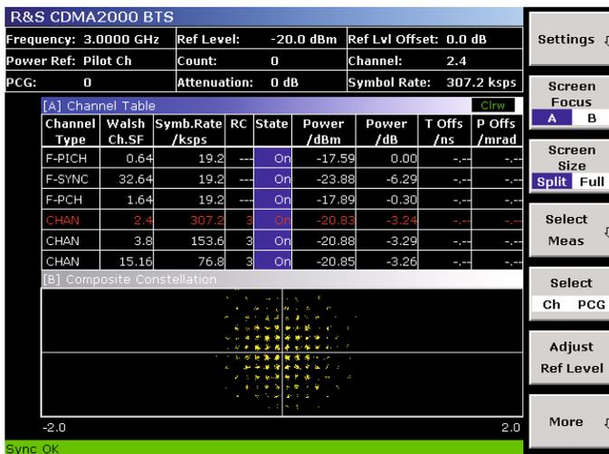
Der obere Teil der Anzeige enthält eine Aufstellung der erkannten Kanäle und eine Anzahl von Parametern wie Leistung und Zeitversatz. Der untere Teil der Anzeige enthält das vollständige Konstellationsdiagramm des Signals.
