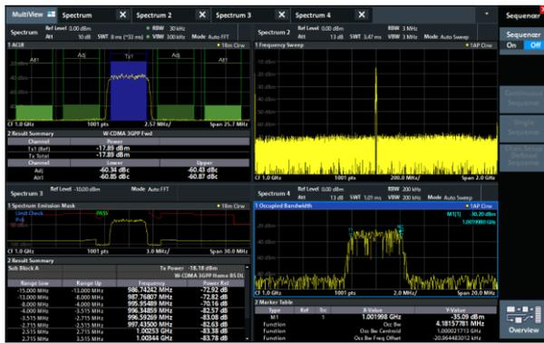
リザルト・ウィンドウをカスタマイズ構成します。異なる測定チャンネルを一度に表示します。逐次チャンネル更新により、スペクトル、スペクトログラム、I/Q解析、アナログ復調などのパラレル測定が可能です。
