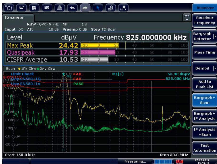
Bewertende Störspannungsmessung mit Quasi-Peak- und Mittelwert-Detektor in Sekundenschnelle.
