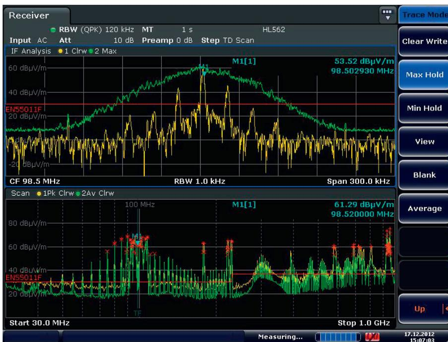
Oberer Bildschirm: Kontinuierliche spektrale Darstellung des HF-Eingangssignals um die Empfängerfrequenz mithilfe der ZF-Analyse. Unterer Bildschirm: Darstellung des gespeicherten Übersichtsscans (Preview). Mit der Funktion „Marker Track“ steuert die Markerposition die Mittenfrequenz im oberen Bildschirm. Alternativ kann das ZF-Spektrum auch mit dem Bildschirm für die numerische und Balkenanzeige (Bargraph) kombiniert werden.
