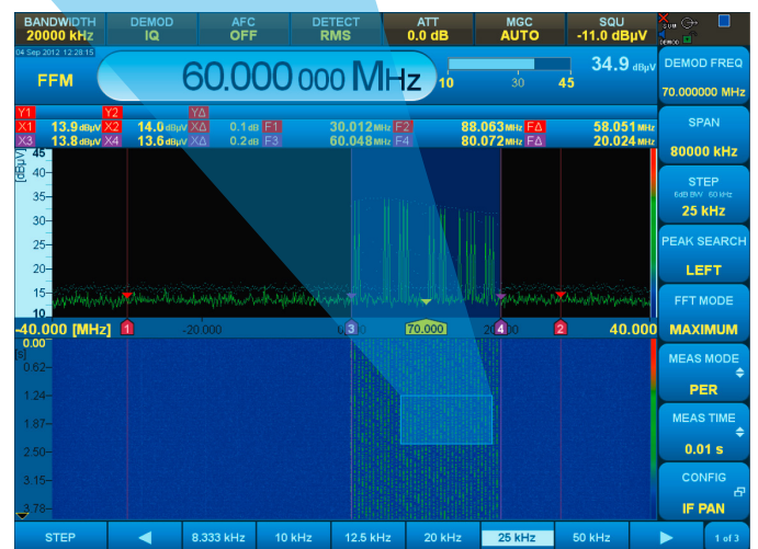
Измерение интервала сигнала со скачкообразной перестройкой частоты в нулевой полосе обзора
