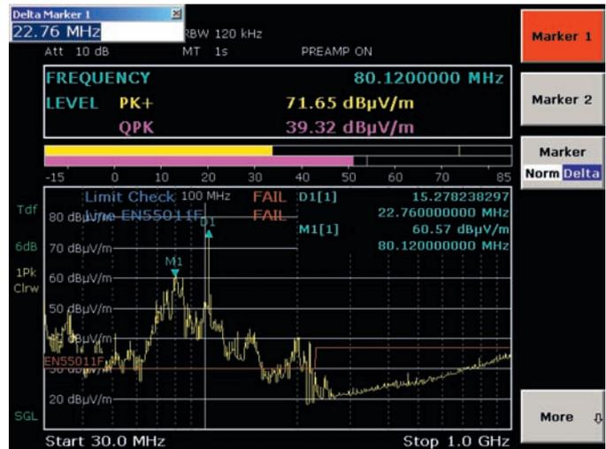
Alle Messkurven können mit Hilfe von Marker- und Zoomfunktionen exakt ausgewertet werden. Die Funktionen „MARKER TRACK“ und „TUNE TO MARKER“ koppeln Frequenzabstimmung und numerische Pegelmessung mit der Markerposition auf der Messkurve. Nachmessungen auf den so ermittelten „kritischen Frequenzen“ sind auf diese Weise wesentlich einfacher und schneller durchführbar
