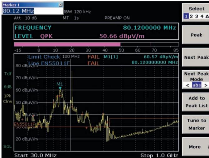
Menü zur Einstellung der Messkurven (Traces). Maximal sechs Messkurven für unterschiedliche Bewertungsdetektoren können dargestellt werden. Die Messergebnisse für die kritischen Frequenzen (Final Meas Detector) werden mit Symbolen angezeigt
