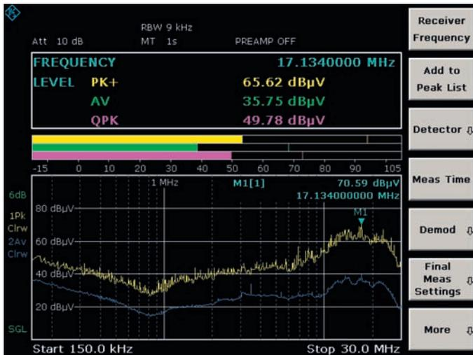
Menü zur Auswahl der wichtigsten Empfängereinstellungen (Empfängerbetrieb). Die standardmäßige „SPLIT-SCREEN“-Darstellung zeigt im oberen Fenster die fortlaufend aktualisierten Pegelwerte für die ausgewählten Detektoren (max. 4) und die eingestellte Messfrequenz. Im unteren Fenster ist das mit den Einstellungen der SCAN-Tabelle erfasste Emissionsspektrum dargestellt. Bis zu sechs Messkurven sind gleichzeitig aktiv
