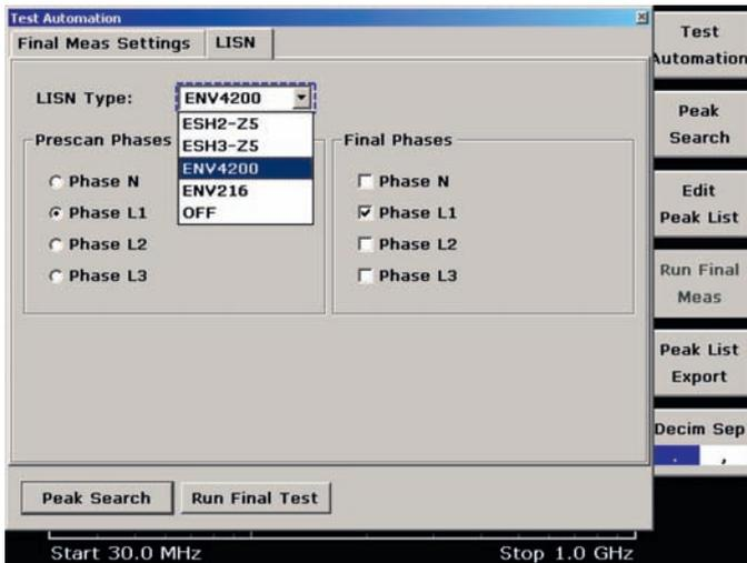
Die normgerechte Erfassung geleiteter Störemissionen mit Netznachbildungen (LISN) erfordert eine Messung auf allen Phasen (Worst-Case-Prinzip). Der R&S®ESL unterstützt diese Messung mit einem vollautomatischen Messablauf (Preview/Final Measurement) einschließlich einer ferngesteuerten Phasenumschaltung für die Netznachbildungen von Rohde&Schwarz
