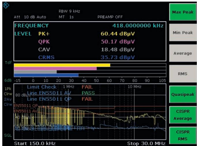
Menü zur Auswahl der Bewertungsdetektoren. Die Werte von maximal vier verschiedenen Detektoren werden gleichzeitig numerisch und in analoger Balkendarstellung angezeigt
