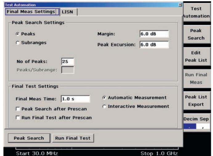
Alle Parameter für die Nachmessung auf den kritischen Frequenzen (Final Meas Settings) können schnell und übersichtlich in einem Fenster konfiguriert werden. Die Nachmessfrequenzen werden entweder für die absoluten Peaks oder als Teilbereichsmaxima ermittelt. Die relative Größe eines Störpegels (Peak Excursion), sein Abstand zum Grenzwert (Margin) und die maximale Anzahl sind einstellbar (1 bis 500). Die Nachmessung selbst läuft wahlweise vollautomatisch oder interaktiv ab
