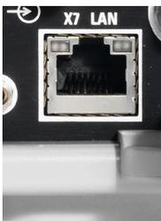
Eine 1-Gbit-LAN-Schnittstelle zur Fernsteuerung und/oder Datenübertragung an der Empfängerrückseite
