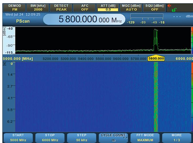
Kurze Signale werden im Wasserfalldiagramm übersichtlich dargestellt und sind durch den Nutzer einfach identifizierbar.
