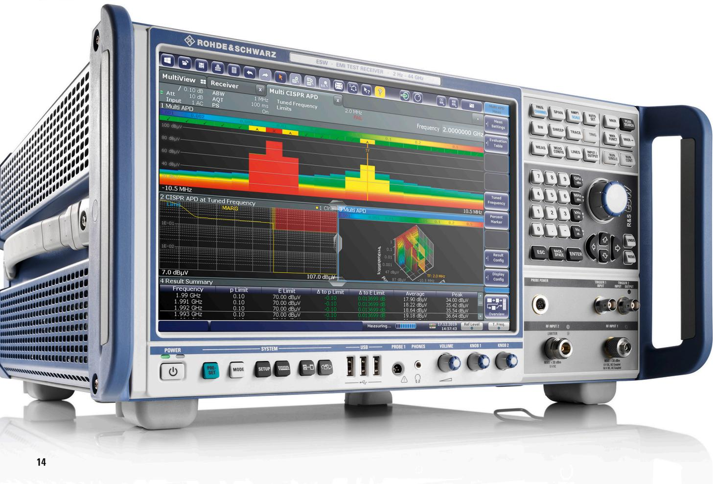
Messeempfänger werden oft durch Störmesssoftware gesteuert. Doch ein „richtiger“ Messempfänger wie der R&S®ESR muss sich analog anfühlen, wenn er von Hand bedient wird, z. B. bei der Frequenzabstimmung per Drehrad. Der R&S®ESR erhöhte den Bedienkomfort zusätzlich durch den erstmalig in dieser Geräteklasse verbauten Touchscreen. Dieses Merkmal hat auch der äußerlich baugleiche aktuelle Precompliance-Bruder des R&S®ESR, der R&S®ESRP.
