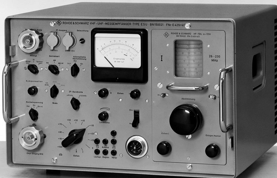
Einen wesentlichen Fortschritt stellte der mitlaufende Eichgenerator dar, der bei jeder Messfrequenz zur Eichung des Geräts herangezogen werden konnte. Erleichtert wurde die Handhabung auch durch wählbare Anzeigebereiche (linear 20 dB, logarithmisch 40 bzw. 60 dB), die umschaltbare Mittelwert- oder Spitzenwertanzeige, eine variable Durchlassbandbreite (25 kHz und 120 kHz) und wahlweise eine automatische Frequenznachstimmung.
