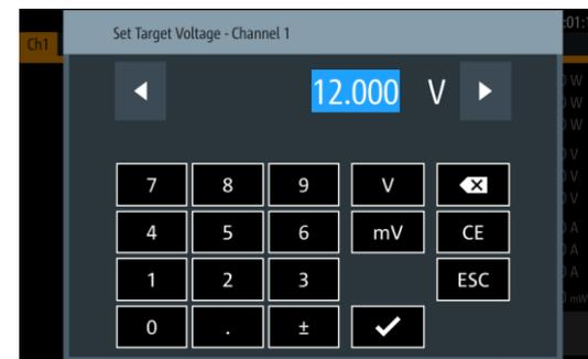
操作の中心は大型の静電容量式タッチスクリーンです。数値を軽くタップすると、仮想キーボードが表示されて希望の値を入力できます。また、回転式ノブを使用して、さまざまな保護機能の電圧、電流、および制限を設定できます。
