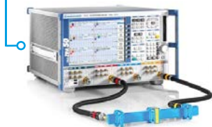
Измерение параметров материалов в волноводе
