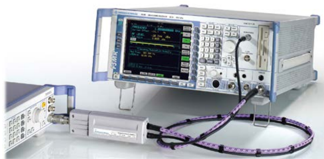
Входной каскад ВЧ-тракта с термопарным преобразователем
