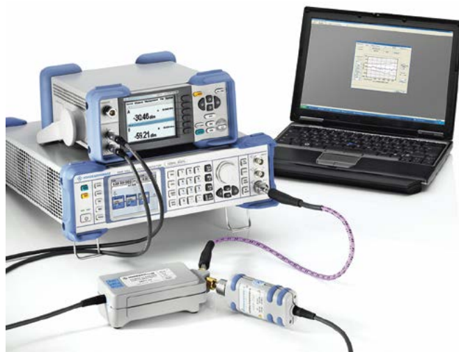
Измерительная установка для калибровки преобразователя мощности NRP-Z55
