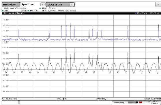
Kabelbelegung mit analogen und digitalen TV-Kanälen und einem DOCSIS 3.1-Kanal und Aufwärtsschräglage.
