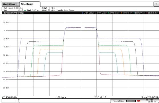
Ausschnitt eines DOCSIS 3.1-Signals in der Umgebung des PLC ohne (blaue Kurve) und mit (schwarze Kurve) Reflexion mit 1 µs Laufzeit.
