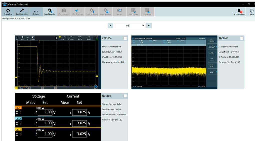
Permite visualizar todos los instrumentos de una mesa en la pantalla de su PC y también el control remoto de cada instrumento
