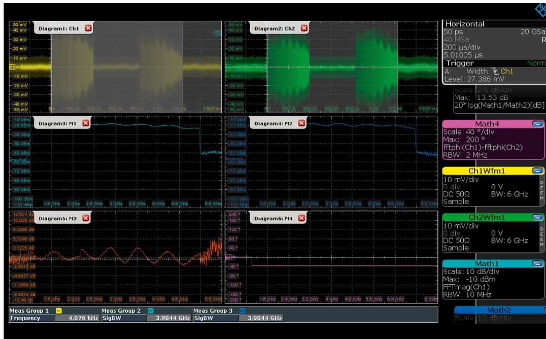
Bild 5: Mehrkanalmessung einer Chirp-Sequenz. Dargestellt sind die Pulse im Zeitbereich (oben), die Spektren der einzelnen Kanäle (Mitte) sowie die Amplituden- (links unten) und Phasendifferenz (rechts unten).
