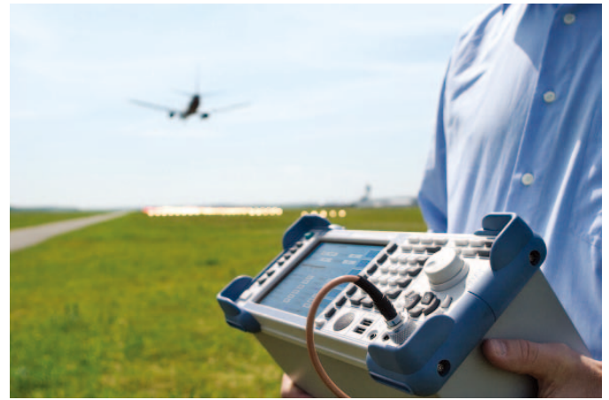
采用EVS300实现外场测试
