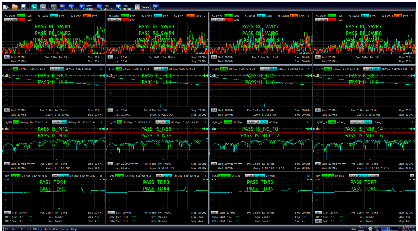
Результаты одновременных измерений с использованием множества портов анализатора цепей R&S®ZNBТ
