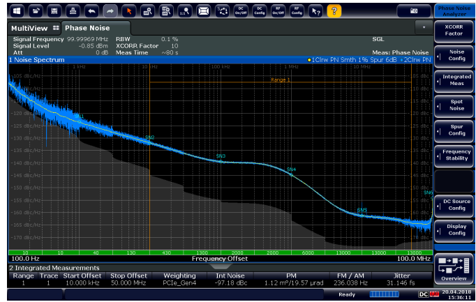
Тактовый сигнал PCIe без SSC: фазовый шум и взвешенный джиттер.
