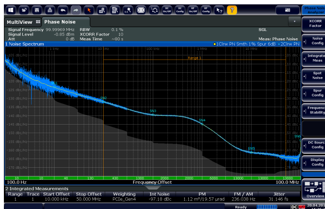
SSC不採用PCIeクロック:位相雑音および重み付けされたジッタ
