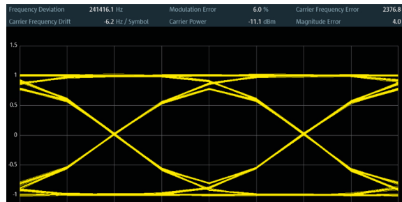
図3 BLE DUTで測定されたBLEのアイダイアグラム
