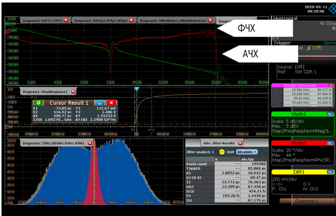
Рисунок 3 — Переходная характеристика испытуемого устройства вместе с осциллограммой и ее преобразование в модуль и фазу.
