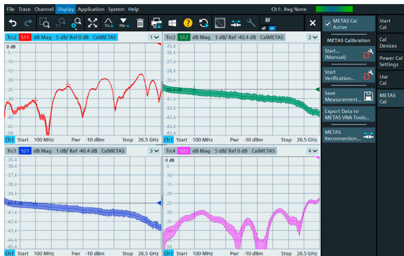
S-параметры аттенюатора 40 дБ с диапазонами погрешности измерения.
