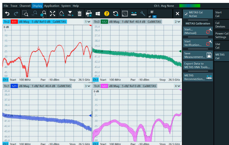
40 dBアッテネータのSパラメータと測定の不確かさの範囲。
