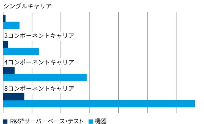
どちらの場合も、振幅レベルの自動調整とI/Qの捕捉は測定器で実行しました。信号解析時間は、コンポーネントキャリアの数に比例して増加しています。各キャリア解析は独立しているため、R&S®サーバーベース・テストでは、他のキャリアと並行して解析することができます。上の図は、R&S®サーバーベース・テストを使用した場合、8つのコンポーネントキャリアの測定に要するテスト時間が、測定器のみのシナリオと比較して89%短縮されていることを示しています。
