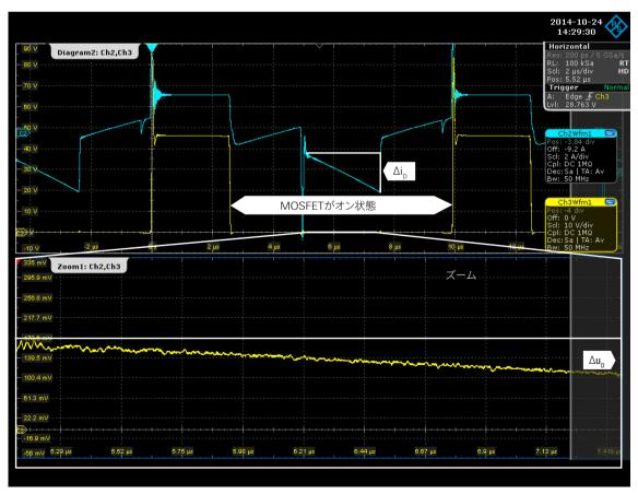
高分解能モードで50 MHz帯域幅で波形アベレージングを使用することにより、16ビットの垂直軸分解能が得られ、大きく拡大された波形が非常に鮮明に表示されます。
