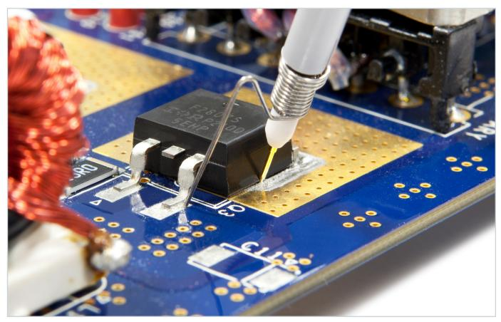
スプリング式のグランドコネクタの使用により、ノイズや干渉の結合を最小限に抑えながら、最高の信号受信を実現します。
