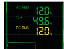
R&S®RTM-K32 DVMオプションを使用して3つのスクリーンショットを並列測定します。
