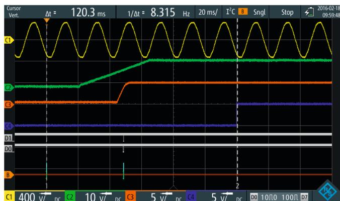
PMBus/I<sup>2</sup>Cコマンドによる組込型AC/DCコンバータの立ち上がり信号
