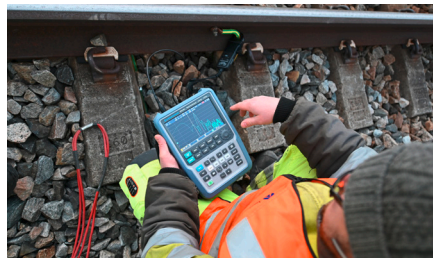
Осциллограф R&S®Scope Rider RTH в режиме измерения спектра измеряет спектральный состав сигнала связи (© Øystein Grue)
