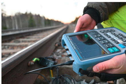
Измерение изоляции железнодорожного пути на разных частотах (© Øystein Grue)
