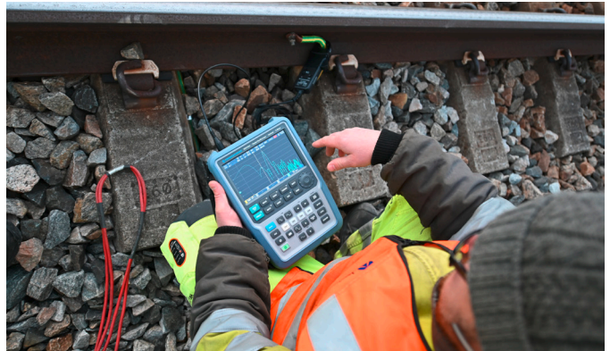
R&S®Scope Rider RTH オシロスコープ (スペクトラムモード) で通信信号のスペクトル成分を測定 (© Øystein Grue)
