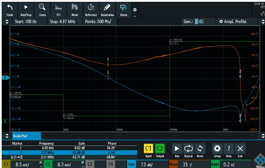
Измерение стабильности преобразователя постоянного тока (синяя кривая: коэффициент усиления; оранжевая кривая: фаза; зеленая кривая: определение профиля амплитуды сигнала входного воздействия)
