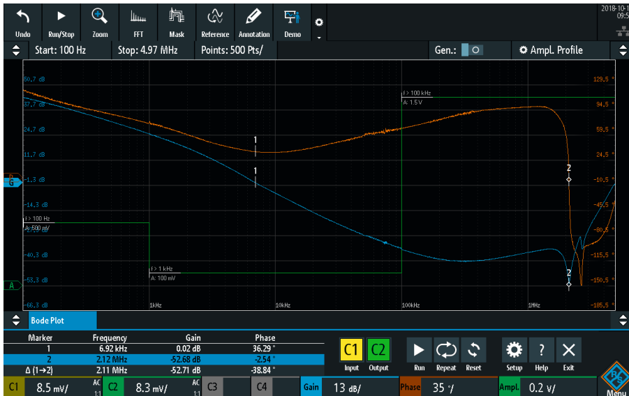
DC/DCコンバーターの安定度の測定(青のトレース:利得、オレンジのトレース:位相、緑のトレース:入力信号の振幅プロファイル)
