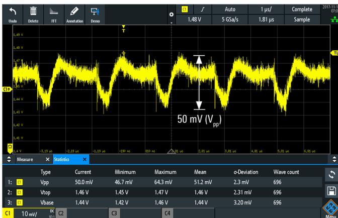
R&S®RT-ZP10 10:1、500 MHz/パッシブプローブを使用して1.5 Vのパワーレールを測定した結果(50 mV (V<sub>pp</sub>))。ノイズによって信号の細部がマスクされています。
