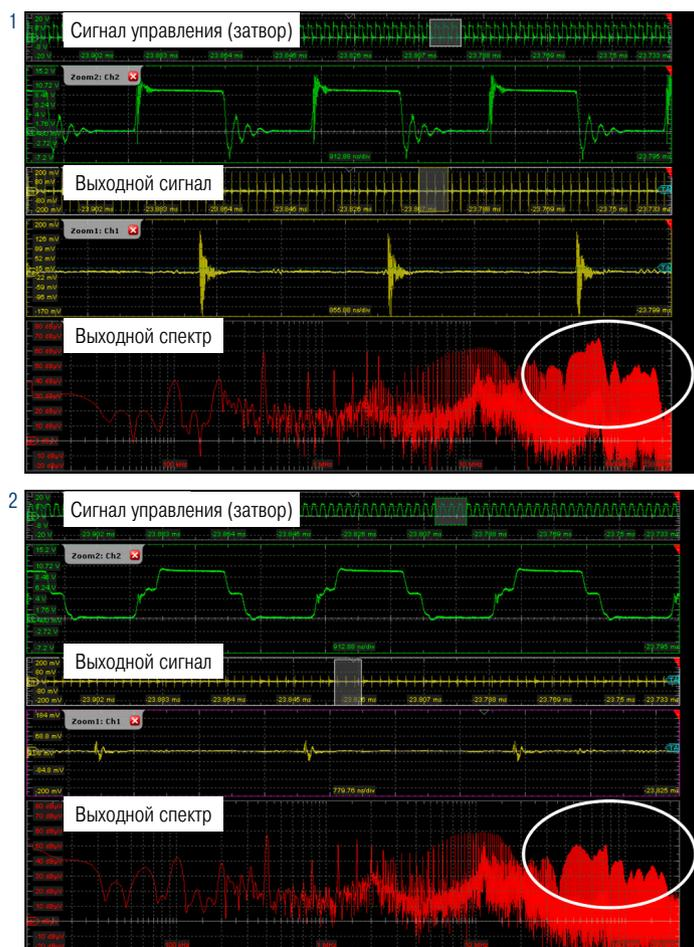
ЭМП узла МОП-транзистора (красного цвета) значительно снижается за счет оптимизации управляющего напряжения затвора (зеленого цвета). В случае (1) использовался прямоугольный управляющий сигнал затвора, тогда как в случае (2) использовался модифицированный двухуровневый управляющий сигнал затвора транзистора.
