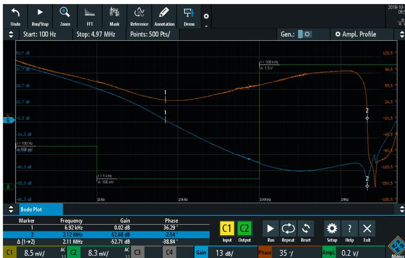
Messung der Stabilität eines DC/DC-Wandlers (blaue Kurve: Verstärkung; orange Kurve: Phase; grüne Kurve: Amplitudenprofil-Messung des Stimulusignals)
