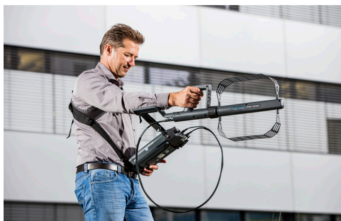
R&S®HE400VHF VHFアンテナモジュールによる干渉探索
