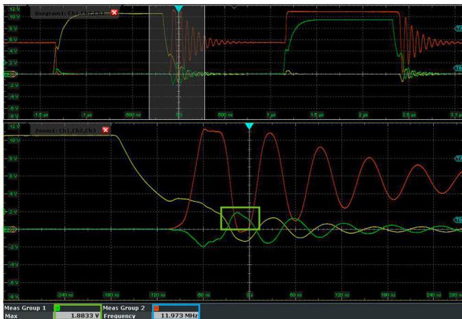
Результат измерения полумостовой конфигурации
