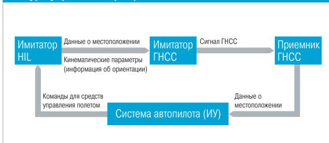
Рис. 1. Схема испытаний с аппаратными средствами в контуре управления (HIL)
