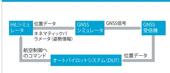
図2: R&S®SMBV100Bが統合されたHiLテストセットアップ
