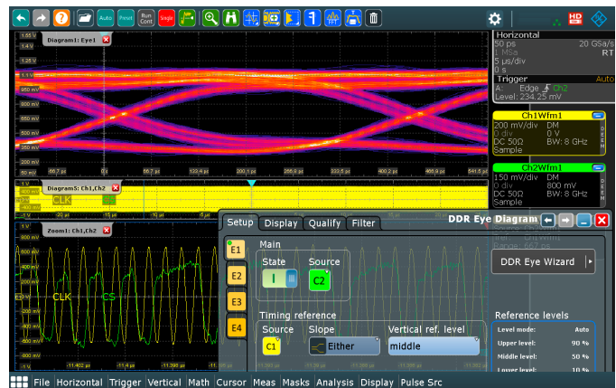
R&S®RTP-K93: глазковая диаграмма DDR сигнала выбора кристалла (CS)
