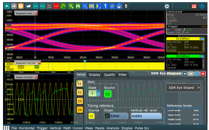
R&S®RTP-K93: チップセレクト信号 (CS) のDDR4アイダイアグラム
