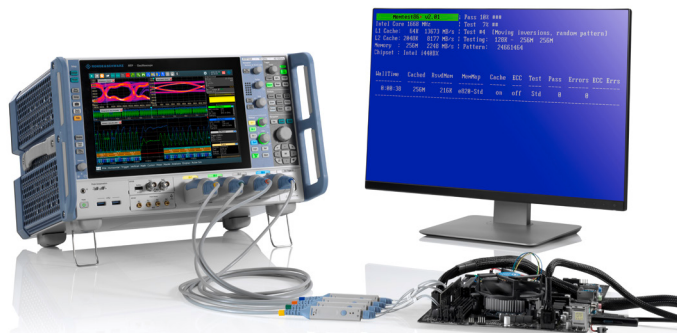
DDR4システムテスト：リード／ライト分離とDQデータアイ
