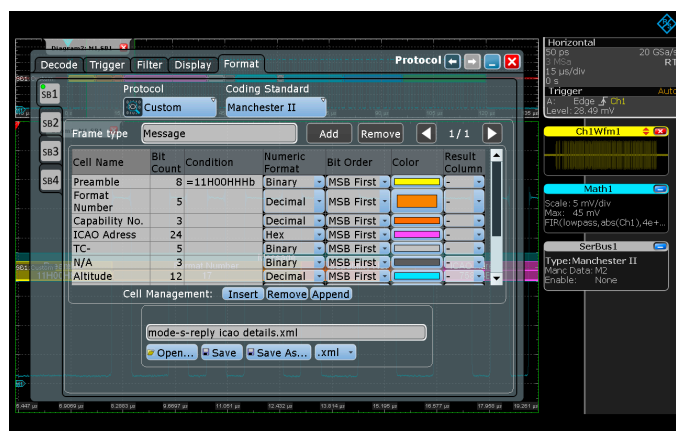
Рисунок 3 — Подробности формата сообщения расширенного сквиттера.
