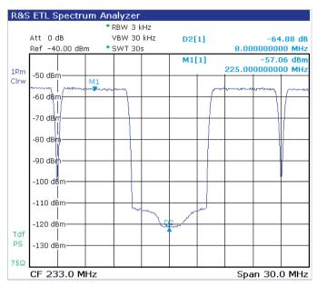
CINR-Messung gemäß unten abgebildetem Messaufbau mit dem R&S°ETL. In Verbindung mit dem externen schmalbandigen Bandpassfilter, dessen Einfluss intern durch vorherige Frequenzganganalyse verrechnet wird, lässt sich ein CINR bis zu ca. 65 dB nachweisen.
