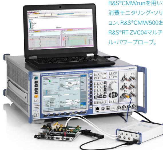
R&S®CMWrunを用いた電力消費モニタリング・ソリューション、R&S®CMW500およびR&S®RT-ZVC04マルチチャンネル・パワープローブ。
