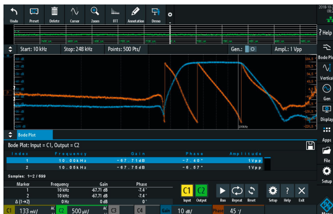
バンドパスフィルターの周波数応答 (青のトレース: 利得、オレンジのトレース: 位相)
