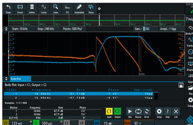
Frequenzgang eines Bandpassfilters (blaue Kurve: Verstärkung; orange Kurve: Phase)
