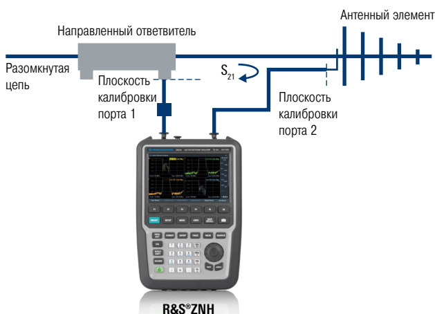
Рис. 2. Измерение относительных параметров передачи S_{21} между элементами антенны с помощью двухпортовой установки
