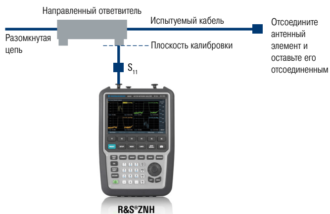
Рис. 1. Измерение относительных параметров отражения S_{11} между кабелями с помощью однопортовой установки
