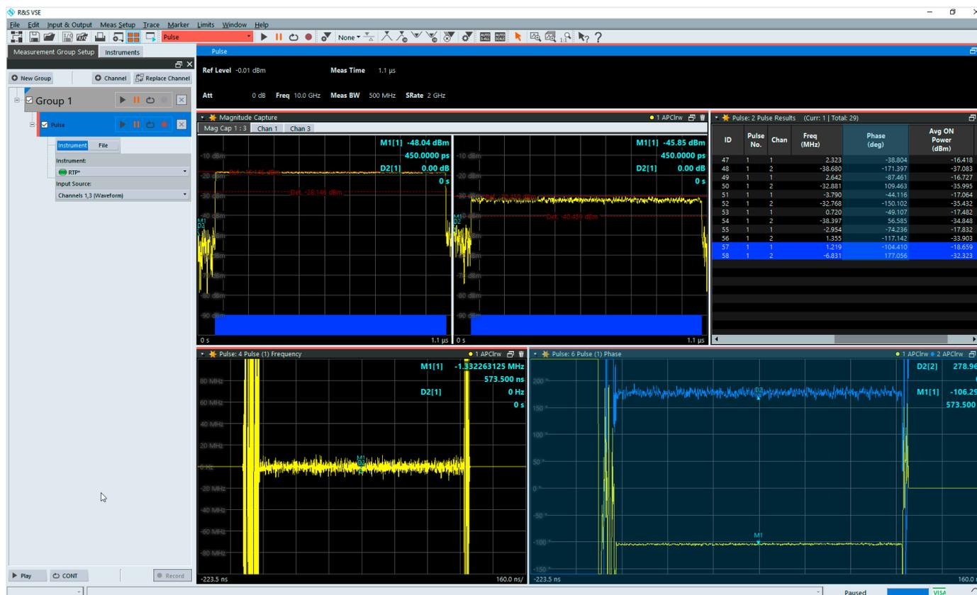
Рисунок 4 — Главное окно анализа опции многоканального анализа импульсных сигналов R&S®VSE-K6A.
