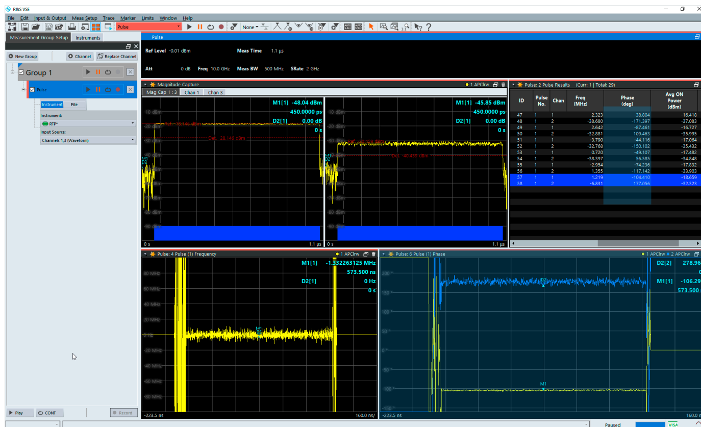
図4: R&S®VSE-K6A マルチチャンネルパルス解析オプションのメイン解析ビュー。
