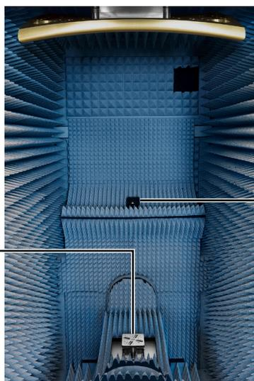
Антенная испытательная камера R&S®ATS1500C
