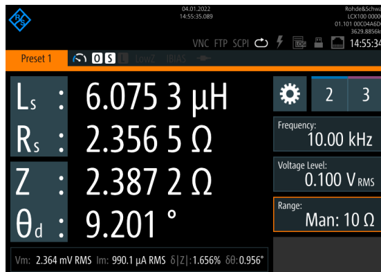
Измерение индуктивности рассеяния при 10 кГц и 100 мВ (СКЗ)
