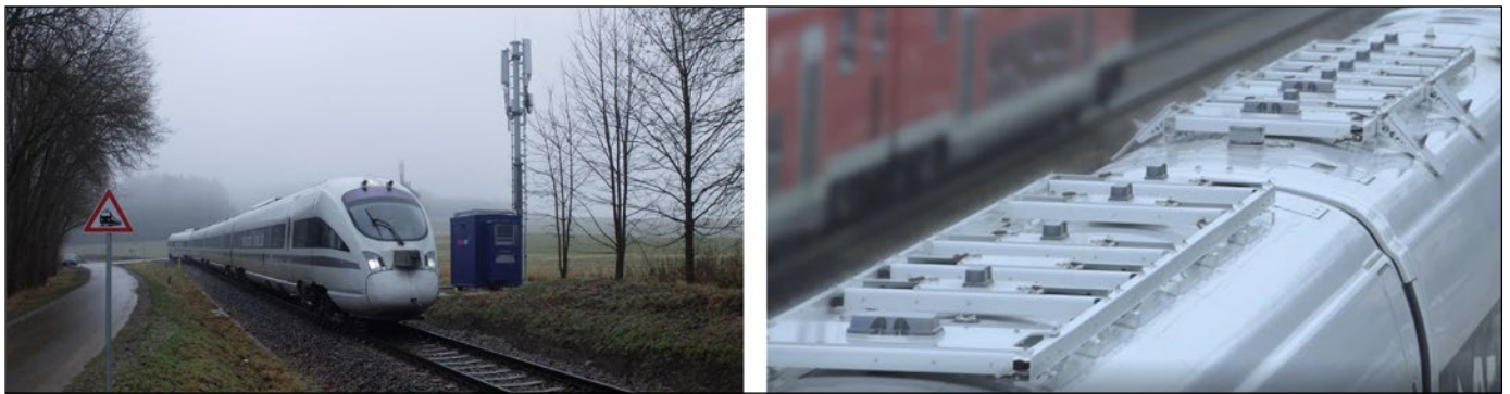
Bild 5: Fotos des „advanced TrainLab“ der DB und des in den Messkampagnen verwendeten Antennenträgers
