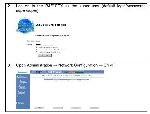
Fig. 12: SNMP configuration
