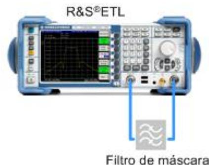
Fig. 23: Configuración de la conexión para evaluar la respuesta en frecuencia del filtro de máscara.
